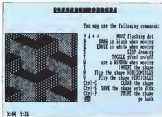
Figura 12 - Tipico esempio di Graphic Editor. Per mezzo di un set di comandi, abbastanza esteso, si comporre un modulo elementare di un'immagine nella composizione del disegno. Quello riprodotto appartiene al pacchetto di Eurographics.
